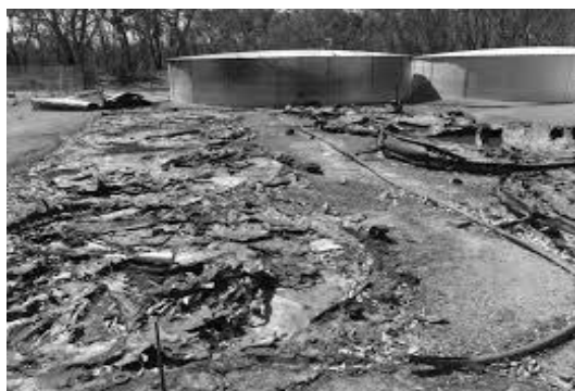
Figura 8. Tanque de plástico fundido
