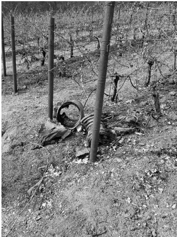
Figura 9. Tuberías de plástico fundidas tras el incendio de 2020 Glass
